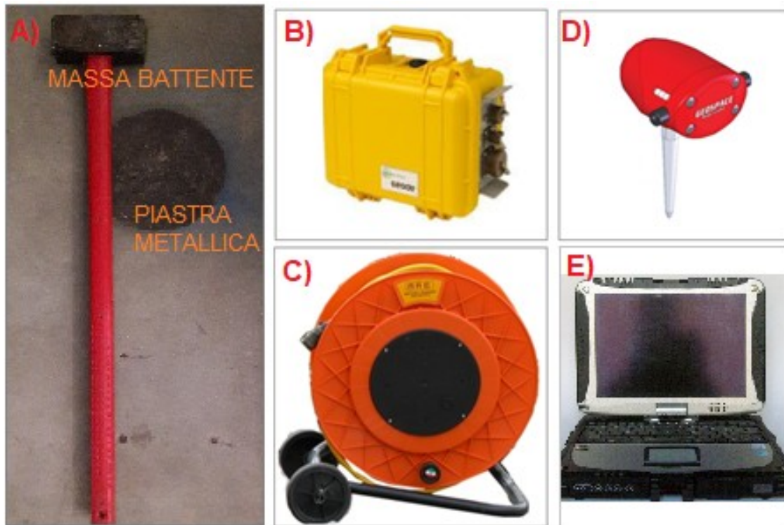
Figura 3 - Strumentazione utilizzata: A) Sistema energizzante; B) Sistema di acquisizione; C) Cavo per prospezione sismica 24 canali; D) Sistema di ricezione; E) Computer di campagna.
